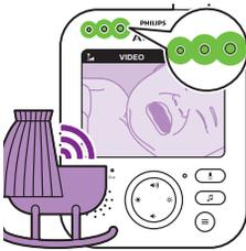
Kad jedinica za bebu otkrije zvuk, jedan ili više indikatora razine zvuka na roditeljskoj jedinici zasvijetlit će zeleno. Broj indikatora koji se uključuju ovisi o glasnoći zvuka koji je otkrila jedinica za bebu. Što glasnije dijete plače, više indikatora za razinu zvuka zasvijetli zeleno.
